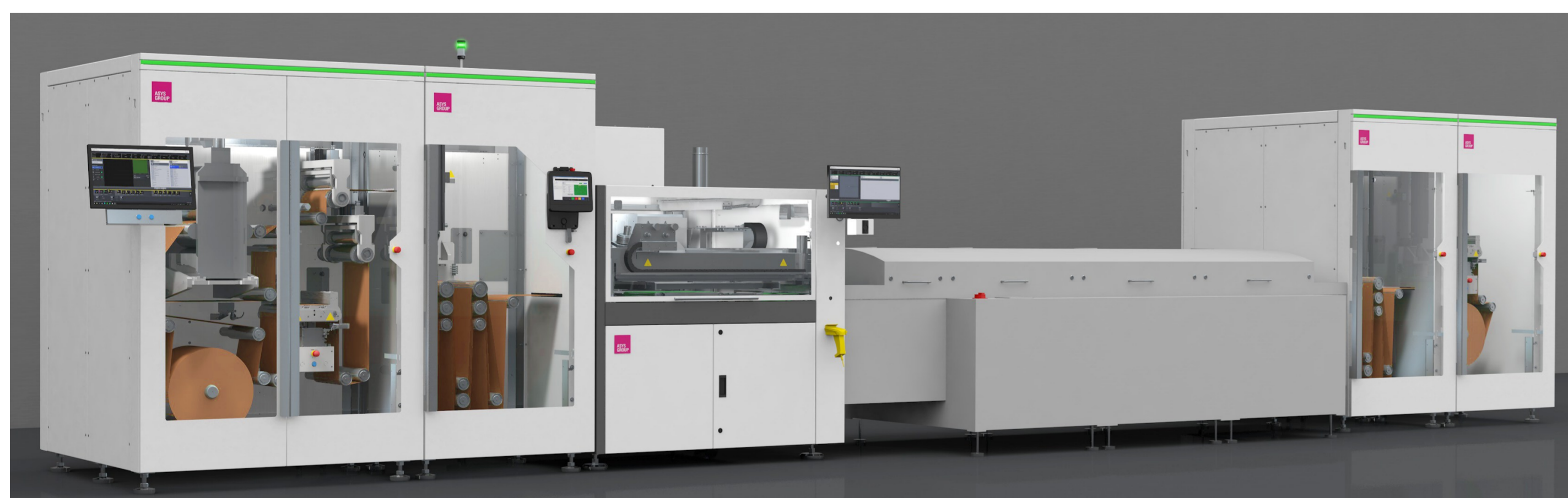
Fertigungslinie für gedruckte Elektroden: Substratabwicklung, Siebdrucker zur Beschichtung, modulare Trocknung (IR und Konvektion), Aufwicklung der Elektroden; Erweiterbare Kalander
